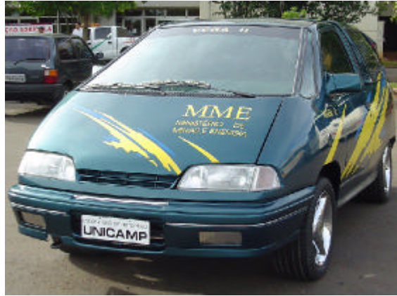
Fig. 3: VEGA II - primeiro veículo elétrico brasileiro movido a célula a combustível.
